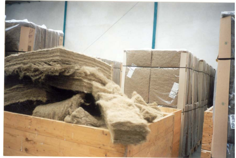
Παραγωγή μονωτικού υλικού από τα υπολείμματα της άγριας αγκινάρας στην Αυστρία
